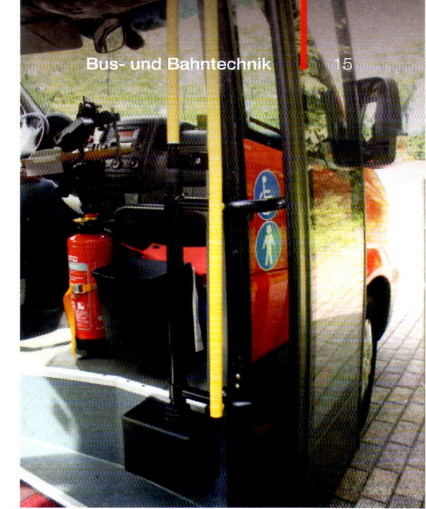
Optisch auffallend die gelben Einstiegshilfen im Türbereich.
