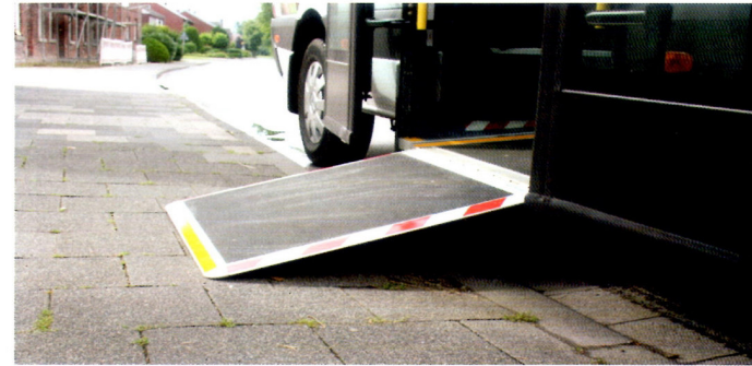
Der Einstieg ist deutlich niedriger. Die Klapprampe ermöglicht den Ein- und Ausstieg mit Rollstuhl oder Rollator ohne fremde Hilfe.
